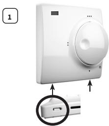
1 Entriegeln Sie mit Hilfe eines kleinen Schraubendrehers vorsichtig die zwei kleinen Haken an der Unterseite.
